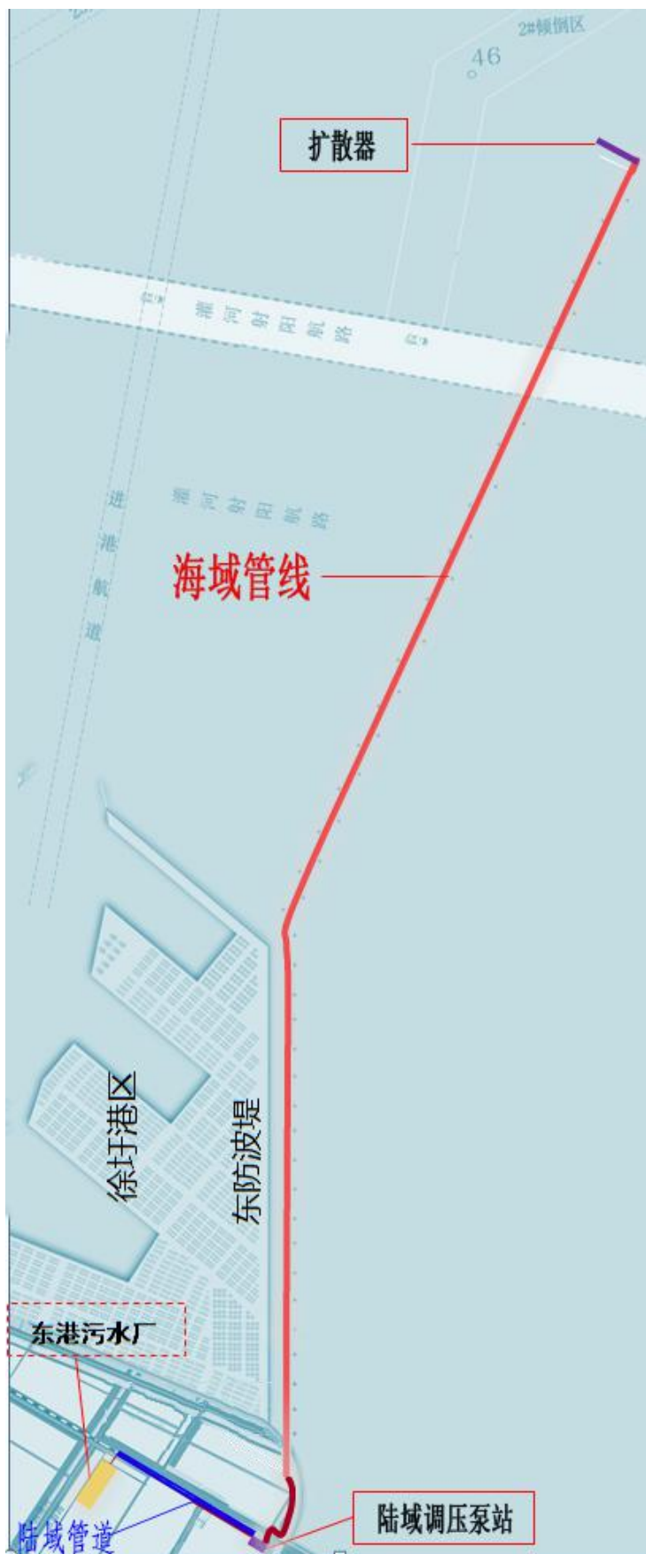
图 5-1 排海工程平面布置图（调压泵站、陆域管线、海域管线和扩散器）
