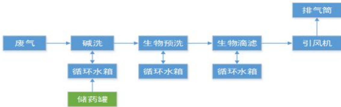
图 6.2-2 除臭系统工艺流程图
